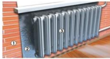
Приклад інсталяції зарадіаторного рефлектора
